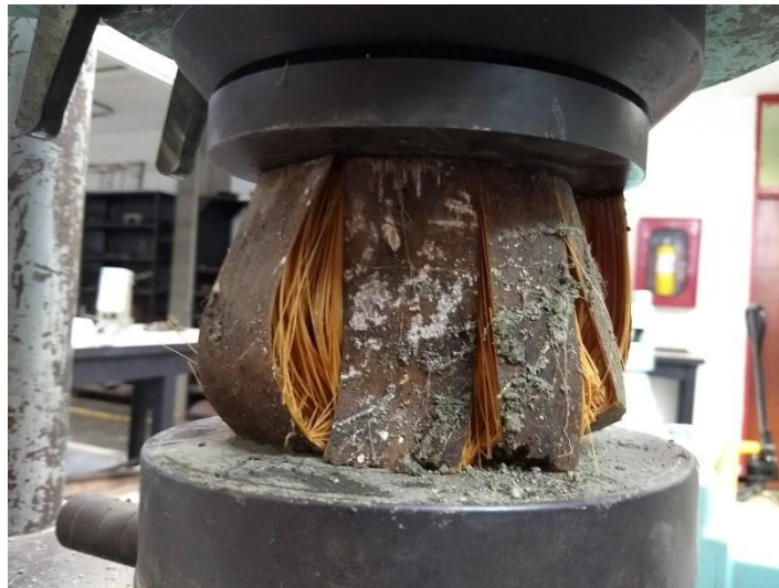
Figura 5.3. Falla típica ensayo a compresión paralela a guadua natural expuesta. Muestra NA-205-S-7.
