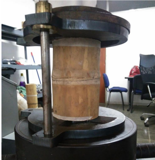
Figura 5.7. Montaje típico ensayo a corte. Muestra IN-010-S-CP-1.
