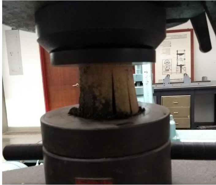
Figura 5.2. Falla típica ensayo a compresión paralela. Muestra IN-008-M-2.
