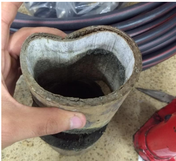
Anexo 8. Ausencia de rigidez debido a la pérdida de la matriz conglomerante de fibras.
