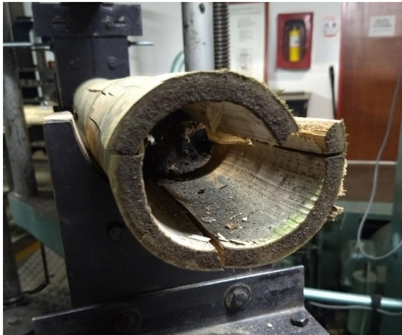
Anexo 10. Falla longitudinal en múltiples puntos en ensayo a flexión.
