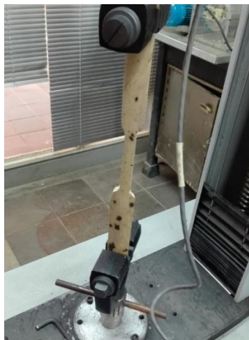
Figura 5.11. Montaje ensayo a tracción. Muestra IN-016-I-T-6.
