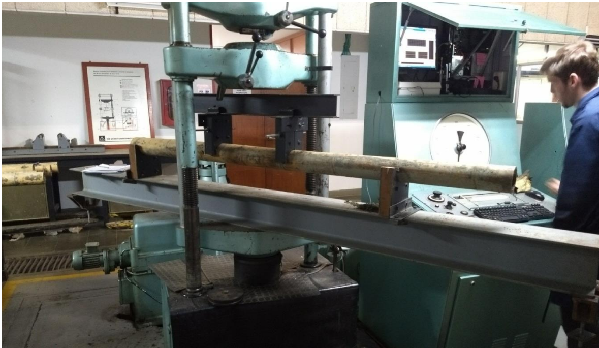
Figura 5.10. Montaje de ensayo a flexión (luz corta y luz larga). Muestra IN-018-M-FC.
