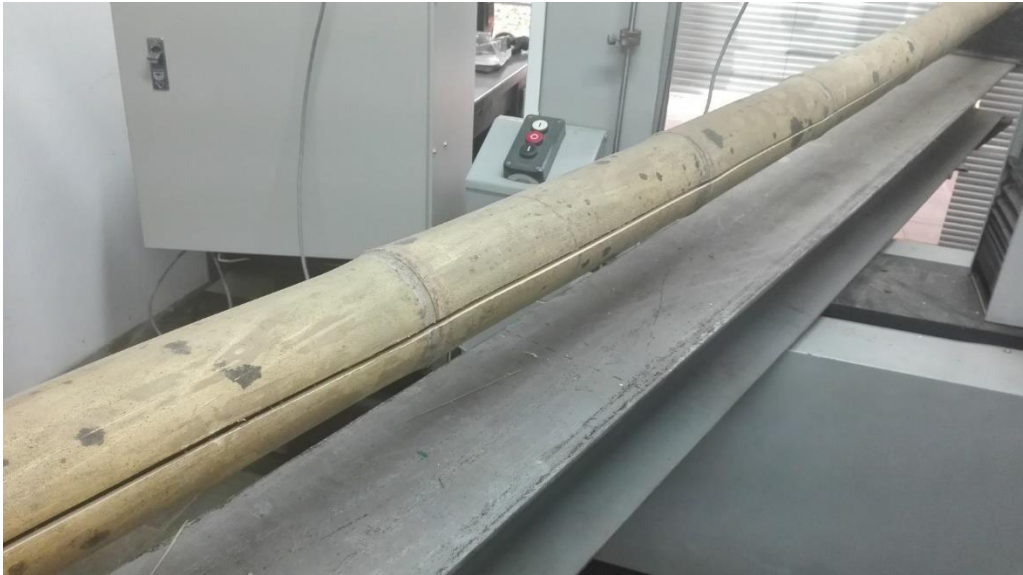
Anexo 6. Falla longitudinal en ensayo a flexión.
