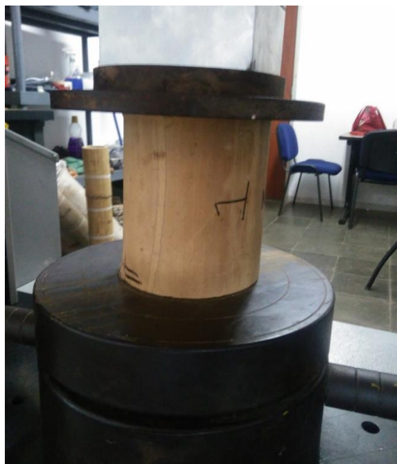
Figura 5.1. Montaje típico ensayo a compresión paralela. Muestra IN-012-M-C-1.
