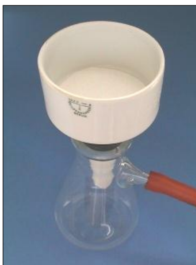
Figura A.9. Sistema de filtración
