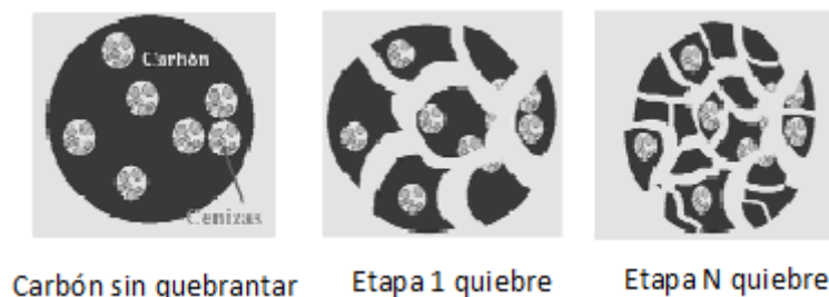
Figura 2.1. Reducción de tamaño y liberación de la materia mineral. [12]
