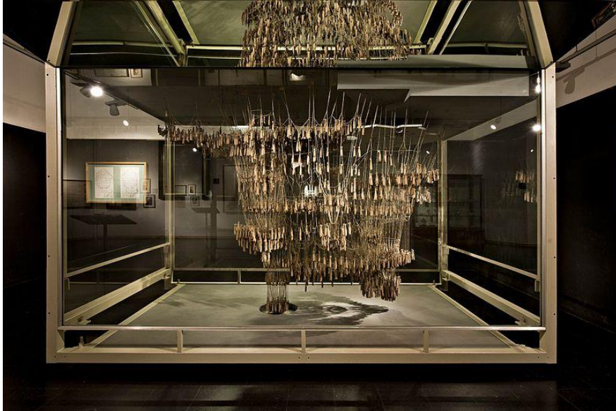
Ilustración 1-Reproducción facsímil de la maqueta poli funicular de la Colonia Güell. Fuente: https://commons.wikimedia.org/wiki/File:Sagrada_Fam%C3%ADlia._Museu_(maqueta_Col%C3%B2nia_G%C3%BCell).jpg
