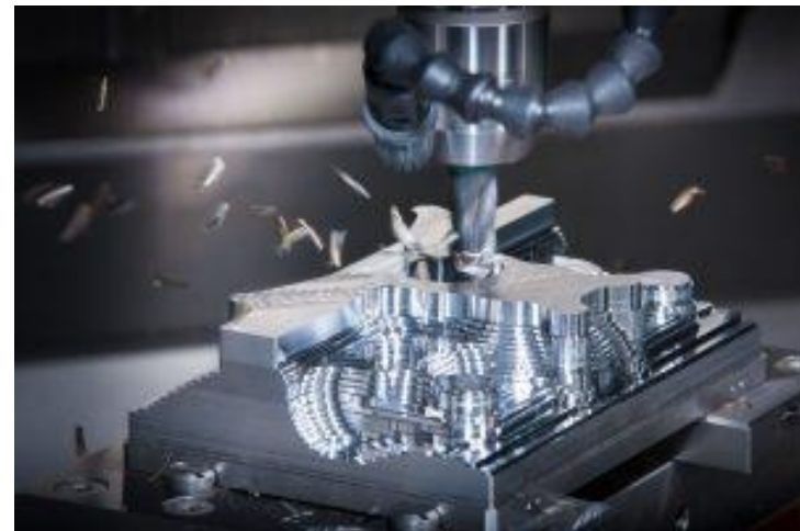
Ilustración 36 - Proceso de fabricación sustractiva. Remoción de material mediante el fresado. Fuente: https://tresde.pe/manufactura-fabricacion-aditiva-vs-fabricacion-sustractiva/
