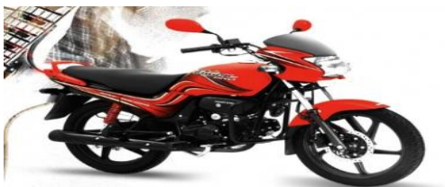
Motor Monocilíndrico de 4 tiempos, OHC Refrigerero por aire , Cilindrada 97.2 cc.
