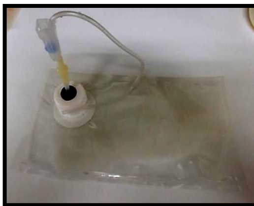
Figura 6. Fermentador diseñado para fermentación láctica de hortalizas
