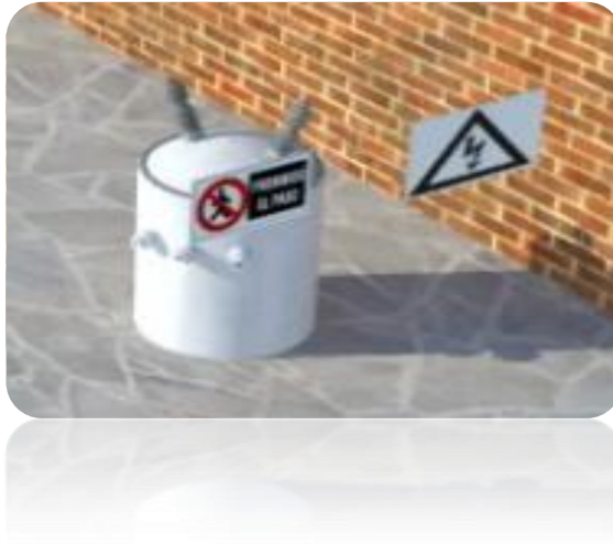
Figura 4. Transformador de distribución de 15KVA.
