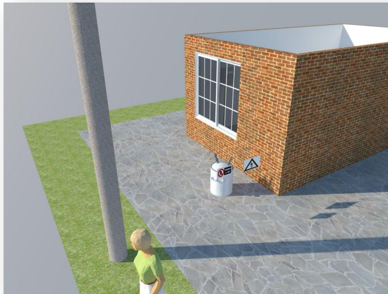
Figura 19. Transformador sumergido en aceite ubicado en un espacio abierto.
