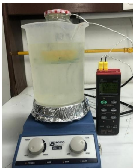
Figura 6. Montaje choque térmico. Elaboración propia.
