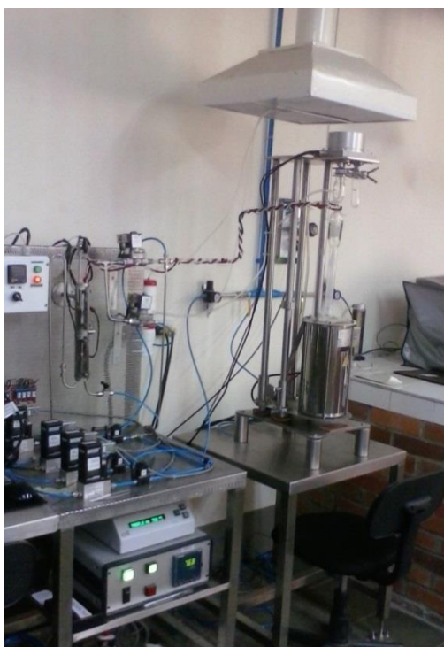
Figura 15. Balanza termogravimétrica ubicada en el laboratorio de Combustión Combustibles de la Universidad del Valle
