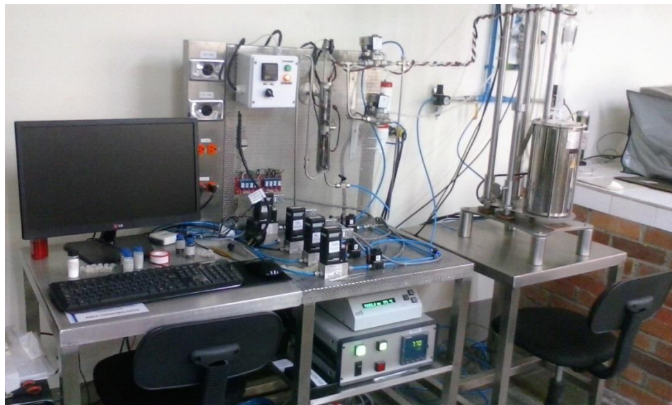
Figura 14. Sistema de termogravimetría ubicado en el laboratorio de Combustión Combustibles de la Universidad del Valle.
