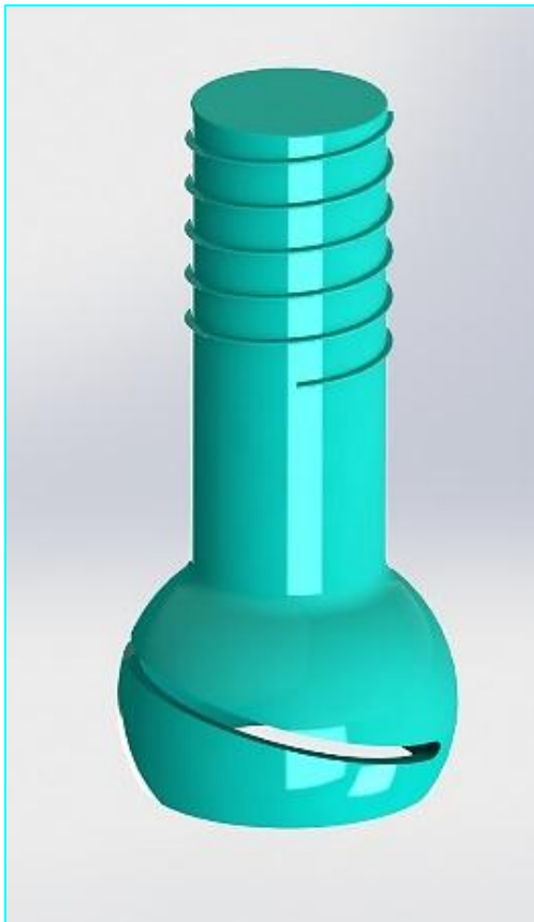
Figura 19: Seguidor de Rotación Interna y externa 0°-50°. Fuente: Autor
