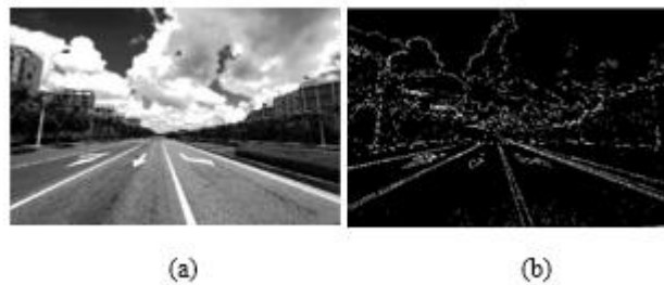
Figura 2.5. (a) Imagen original (b) Filtro Sobel aplicado. Tomado de [13].
