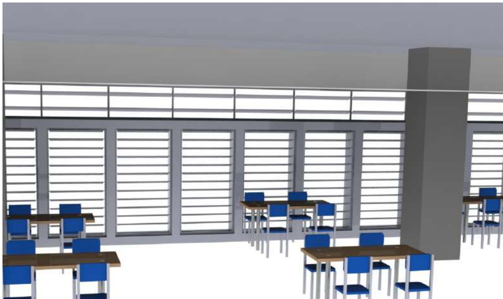
Imagen 75. Permiten la ventilación y el paso del aire. Cortasoles en aluminio.
