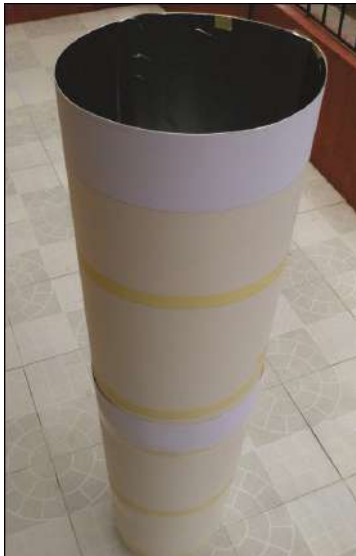
Fotografía 18. Ducto de carton con película metalizada reflectante al interior
