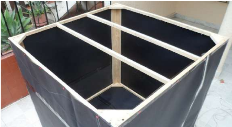
Fotografía 19. Cubo con paredes negras de 1mt X 1mt
