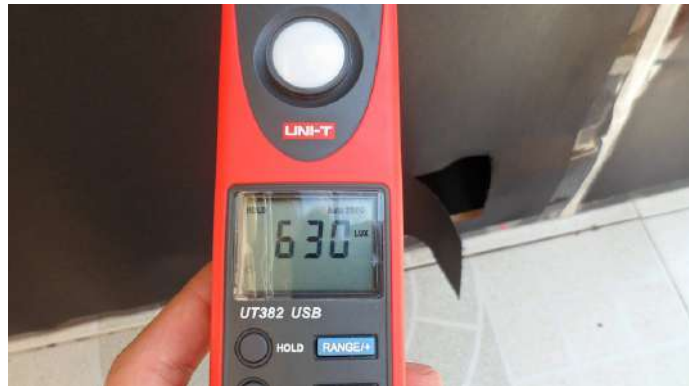
Fotografía 22. Nivel de luxes en al interior con llux.
