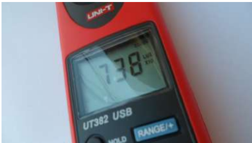
Fotografía 21. Nivel de luxes en el exterior de la caja.
