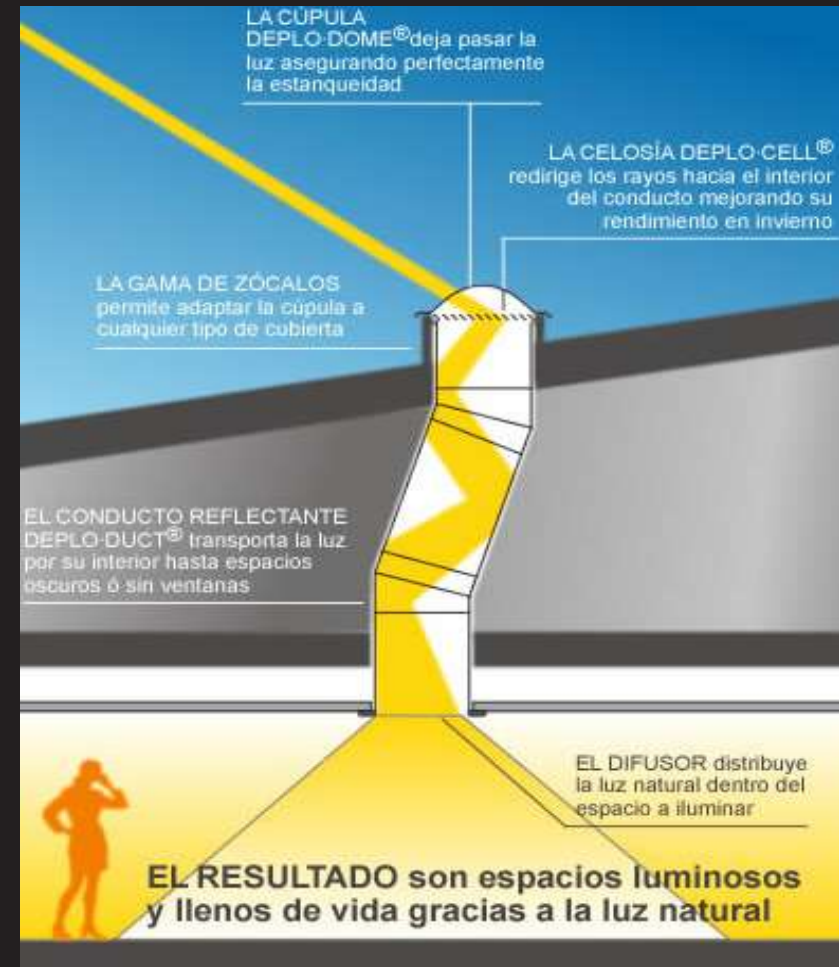
Imagen 32. Funcionamiento de un ducto de luz. Fuente: http://espaciosolar.com/img_v1/ES_tubos_fq_1.jpg
