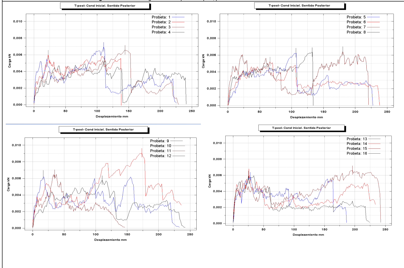
Figura C.3 Resultados gráficos de la prueba T-peel; para lado Posterior en condiciones estándar
