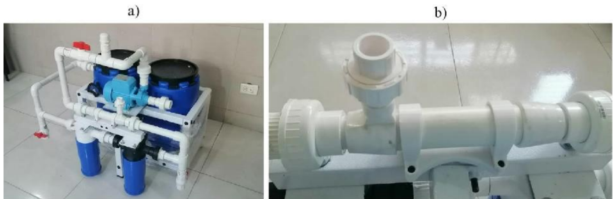
Figura 1. (a) Montaje general de la planta de potabilización portátil, (b) sistema de mezcla.
