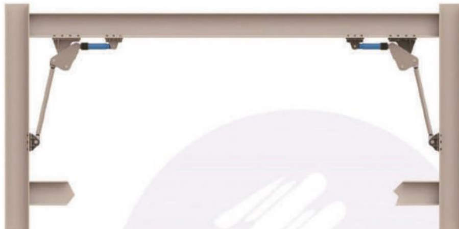
Figura 15 Amortiguadores en pórticos de espacio abierto ( Open Space Systems ) [35].
