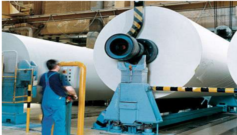
Figura 10. Bobinas finales sobre el Stan Reel
