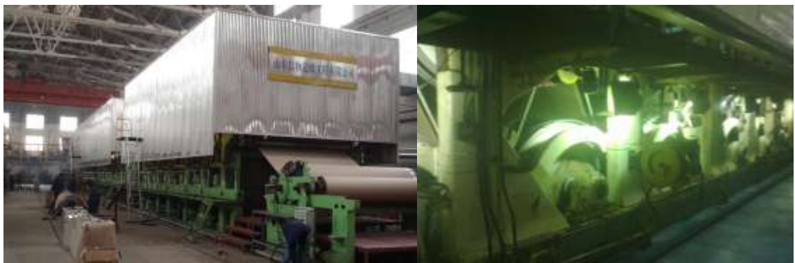
Figura 9. Sección de secadores, área de secado del papel.
