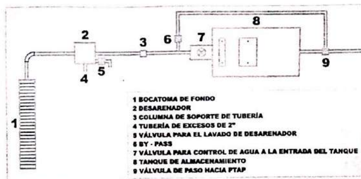
Figura 5. Sistema de captación de agua para Montebello
