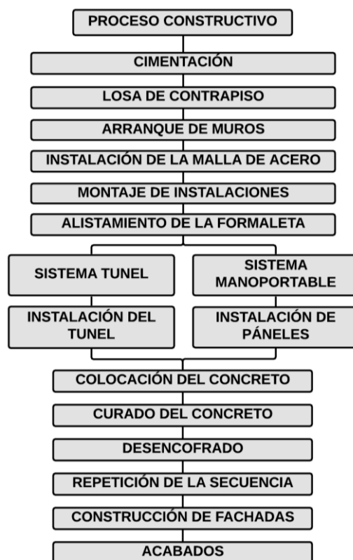
Figura 3. Proceso constructivo del sistema de MDCR. Fuente: Revista Construdata ed. 143 (2007).
