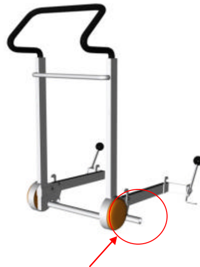
Nicho del mecanismo de bloqueo de la rueda 24". Impide que la rueda entre más de lo debido
