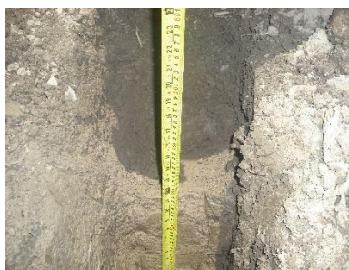
Figura 7. Calicata para muestras alteradas a una profundidad de 0-25 cm y 25-50 cm
