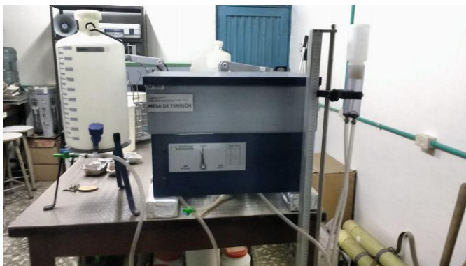
Figura 8. caja de arenas o mesa a tencion para determinacion de porosidad del suelo
