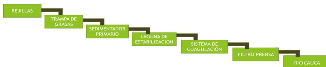
FIGURA 7 Tren de tratamiento de lixiviados relleno sanitario El Ojito.
