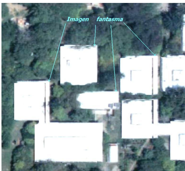
FIGURA 11 –EFECTO FANTASMA PRODUCIDO AL REALIZAR UNA ORTORECTIFICACIÓN SIN DETECCIÓN DE ZONAS OCULTAS.
