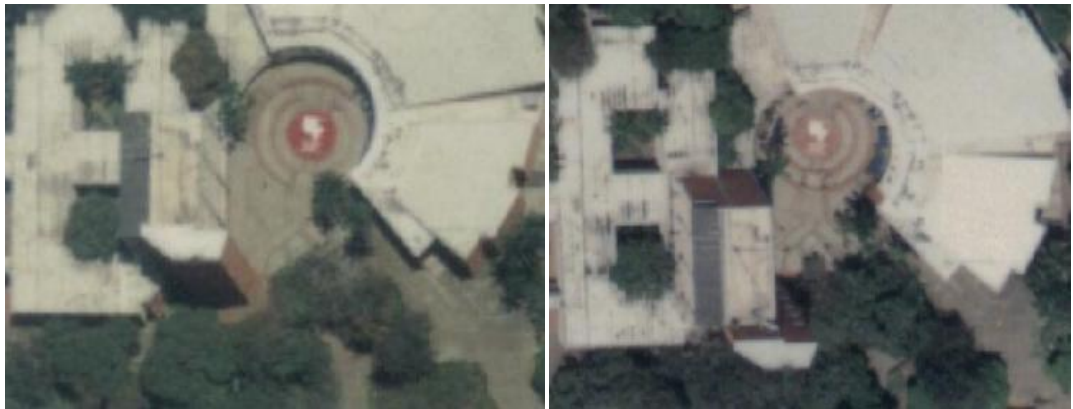
FIGURA 4- DESPLAZAMIENTO DEL RELIEVE DEBIDO A LA PROYECCIÓN CENTRAL EN FOTOS AÉREAS, VISTA DESDE DIFERENTES POSICIONES DEL PUNTO NADIR.
