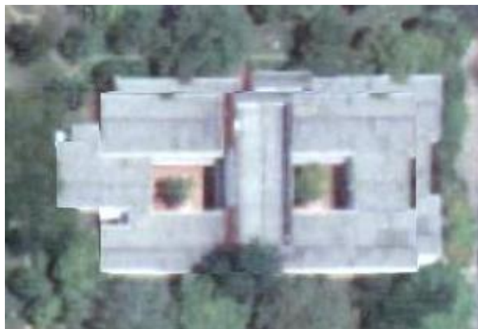
FIGURA 6 - IMAGEN ORTORECTIFICADA CON LOS PROCESOS EXISTENTES DE GENERACIÓN DE ORTOFOTOS. EL EDIFICIO ESTA RECTIFICADO EN SU CORRECTA POSICIÓN PERO UNA “IMAGEN FANTASMA” DEL EDIFICIO ESTÁ COLOCADA EN SU POSICIÓN DE ORIGEN.
