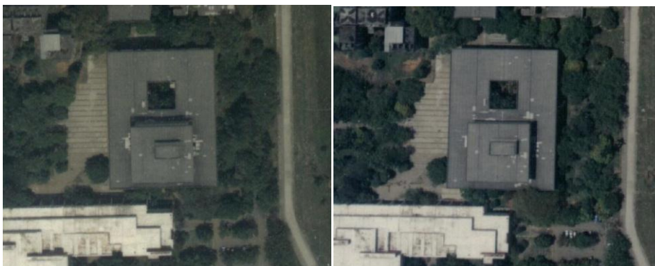
FIGURA 16- DIFERENCIAS DE TONALIDAD EN LAS LÍNEAS DE VUELO. FOTO AÉREA DE LA IZQUIERDA CON TONALIDAD AMARILLA, FOTO AÉREA DE LA DERECHA CON TONALIDAD AZULADA.
