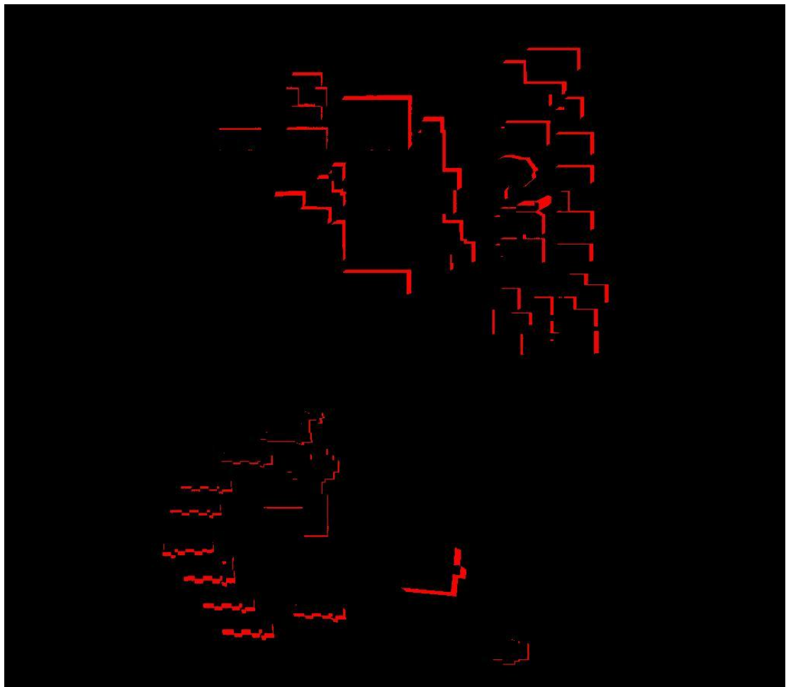
FIGURA 30— MAPA DE VISIBILIDAD DE LA ZONAS OCULTAS POR LAS EDIFICACIONES, EN ROJO LAS ZONAS OCULTAS POR LAS EDIFICACIONES POR LA PROYECCIÓN EN PERSPECTIVA.
