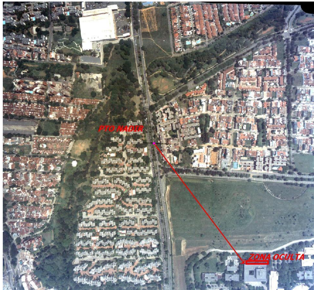
FIGURA 13— DISTANCIA DE UNA ZONA OCULTA AL PUNTO NADIR, A ESTA IMAGEN SE LE ASIGNA UN VALOR MENOR COMPARADO CON LA FIGURA 14, POR TENER MAYOR DISTANCIA AL PUNTO NADIR.
