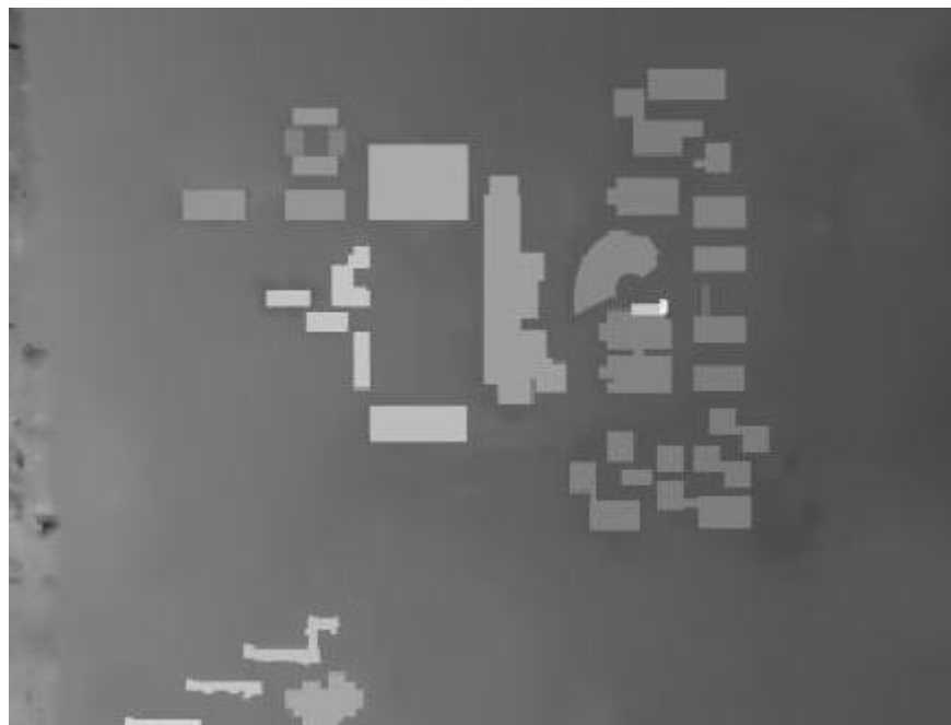
FIGURA 28 – MODELO DIGITAL DE SUPERFICIES OBTENIDO EN EL PROYECTO, LOS DIFERENTES TONOS DE GRISES REPRESENTAN LAS ALTURAS DEL MODELO, ENTRE MÁS CLARO MAYOR ES LA ALTURA, FORMATO GRID.
