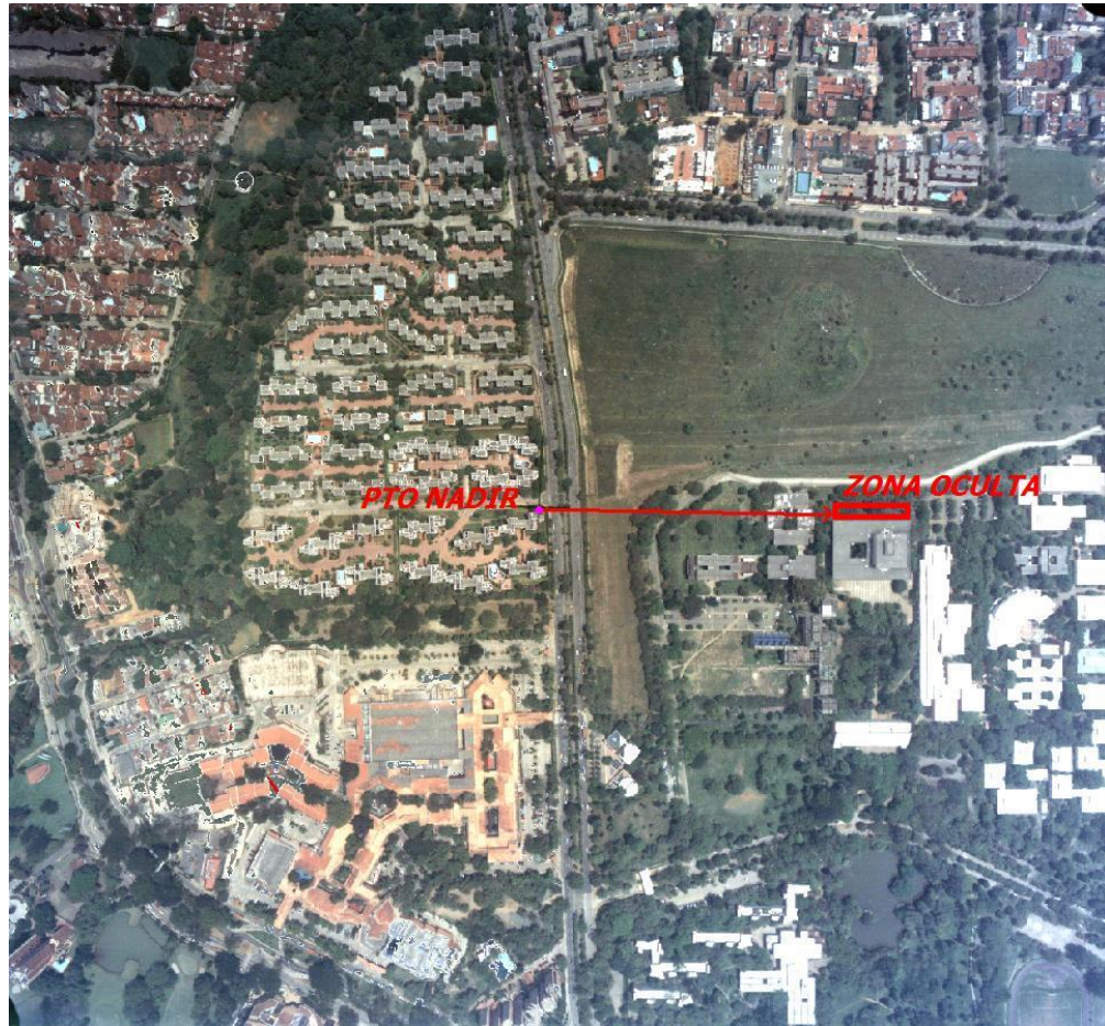
FIGURA 14—DISTANCIA DE UNA ZONA OCULTA AL PUNTO NADIR, A ESTA IMAGEN SE LE ASIGNA EL VALOR MÁS ALTO COMPARADO CON LA FIGURA 13, POR SER LA IMAGEN CON MENOR DISTANCIA DE LA ZONA OCULTA AL PUNTO NADIR.
