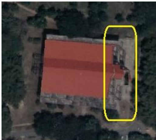
FIGURA 33— ERROR PRODUCIDO EN LA ORTOIMAGEN VERDADERA POR IMPRECISIONES EN EL MDS.
