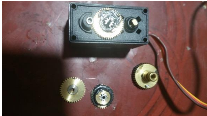
Figura. 33. Cambio en engranaje servomotor Mg996r.
