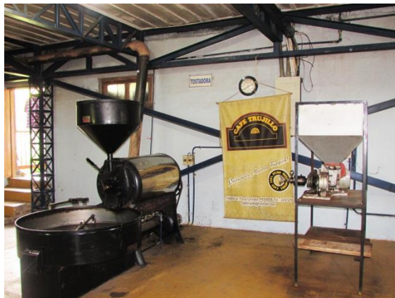
FOTO 20. Maquinaria utilizada en el proceso de tostado del café (segunda y tercera calidades), finca La Julia.
