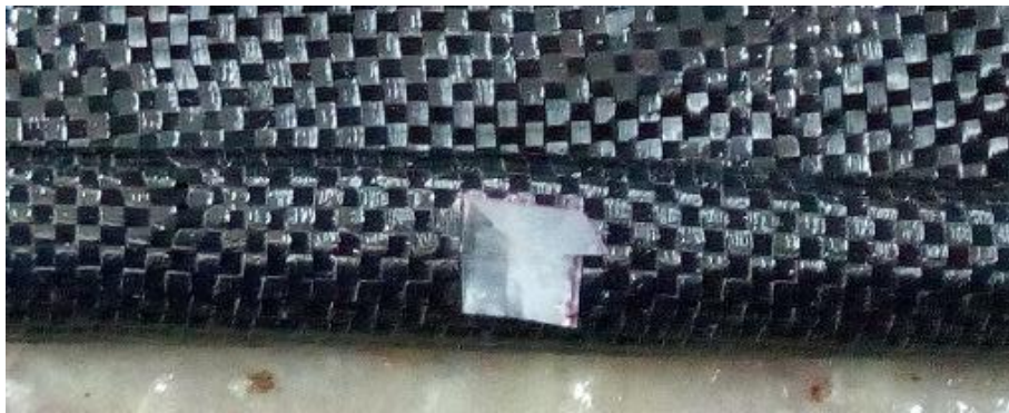
Figura 4.4 Daño controlado, delaminación con teflón insertada entre las capas durante la construcción del elemento tipo placa.
