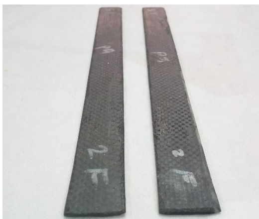
Figura 4.2 Elemento tipo placa terminado, construido en material fibrorreforzado.
