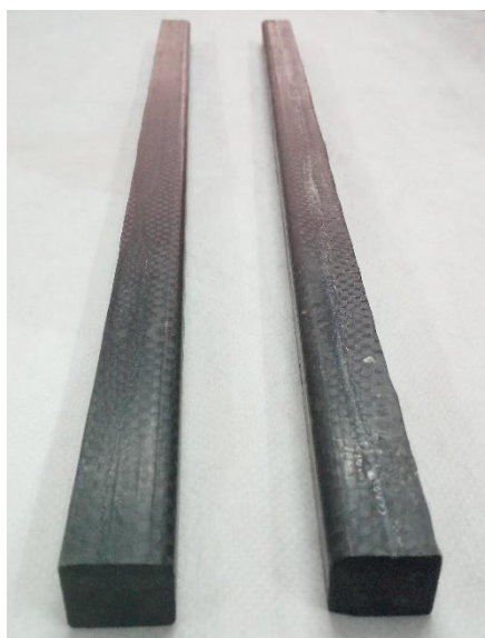
Figura 4.3 Elemento tipo riel terminado, construido en material fibrorreforzado.
