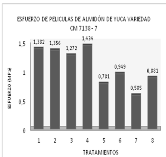
ESFUERZO DE PELÍCULAS DE ALMIDÓN MODIFICADO DE YUCA VARIEDAD CM 7138-7
