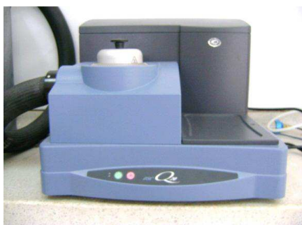
Figura 8. Calorímetro de barrido diferencial
