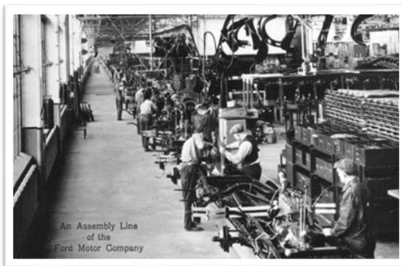
Ilustración 1. Ford introduces the integrated moving assembly line to auto production. Fuente:
