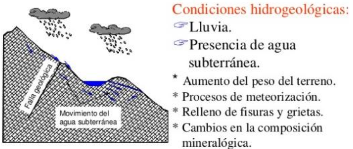
Figura 33. Causas de desestabilización
