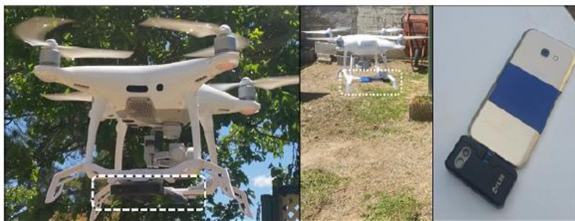
Figura 2. 4. Sistema de Inspección termográfico mediante un dron propuesto por [40].
