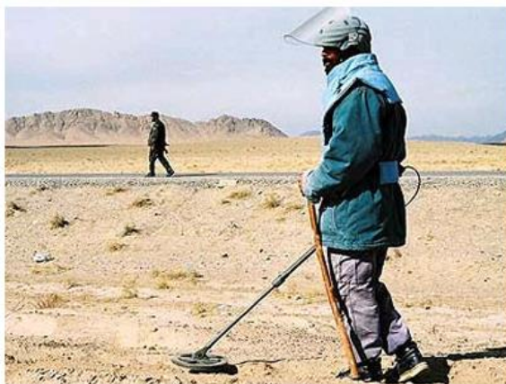
Figura 2. 6. Detector de Metales para la detección de MAPs [74].
