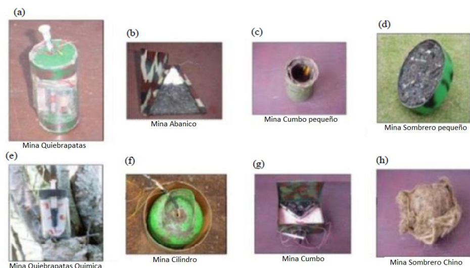
Figura 2. 5. Diferentes Minas Antipersonal Artesanales usadas en Colombia: a) Mina Quiebrapatatas, b) Mina Abanico, c) Mina Cumbo pequeño, d) Mina Sombrero pequeño, e) Mina Quiebrapatatas Química, f) Mina Cilindro, g) Mina Cumbo, h) Mina sombrero Chino [72].
