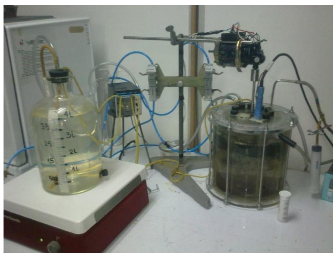
Anexo 2d. Fotografia sistema de agitación, carga y almacenamiento de sustratos.
