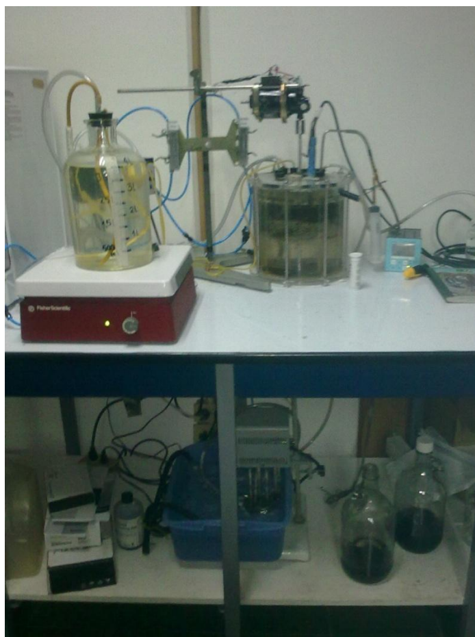
Anexo 2d. Fotografia sistema de agitación, carga y almacenamiento de sustratos.
