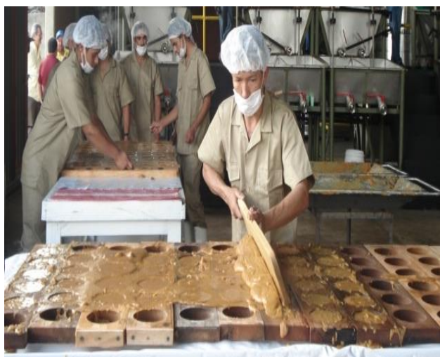
Ilustración 13. Operarios realizando el proceso de moldeo de panela en las gaveras.
