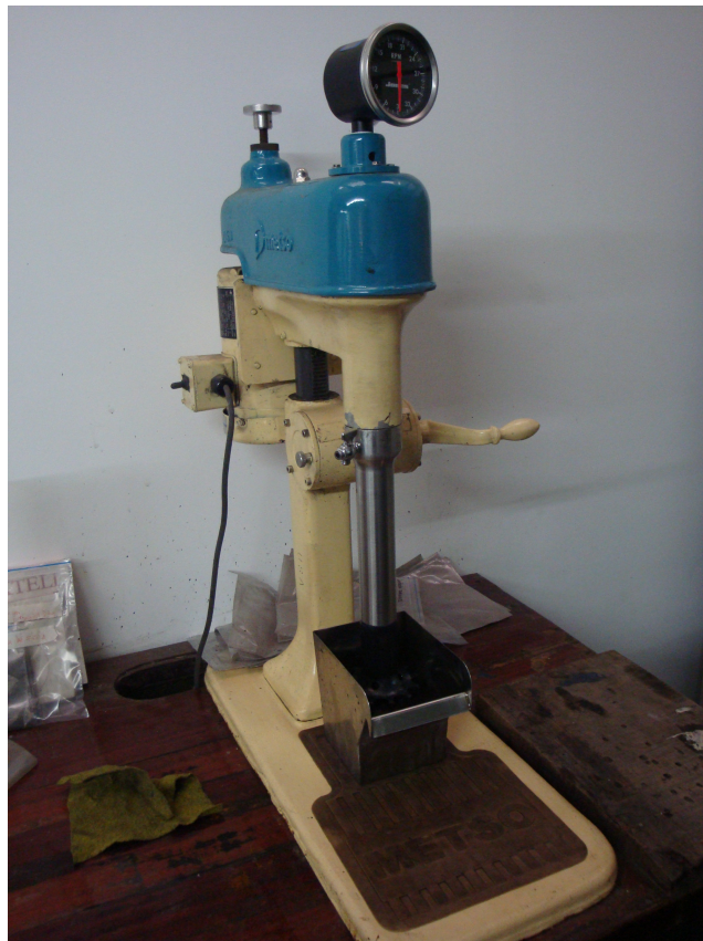
Figura 5: Celda de flotación del laboratorio del GCTC
