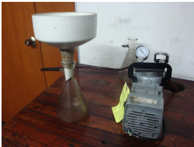
Figura 6: Sistema de filtración
