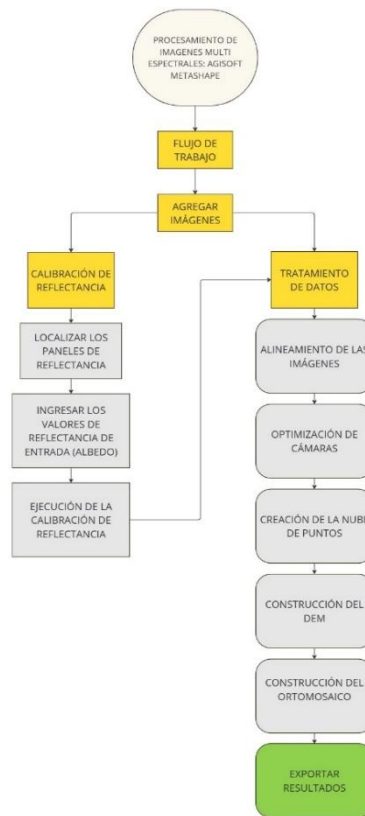
Figura 10 Diagrama de flujo - procesamiento de las imágenes multispectrales en Agisoft Metashape Fuente: Autores
