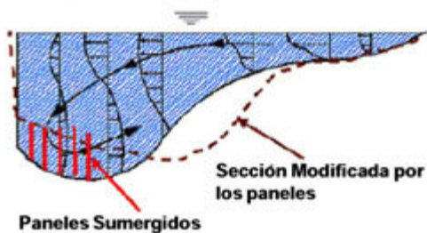
Figura 2. Esquema de la acción resultante de las fuerzas secundarias erosivas del talud y del efecto directo de los paneles en el control de la erosión del talud izquierdo, por redistribución de los sedimentos en la sección con modificación de la sección transversal.
