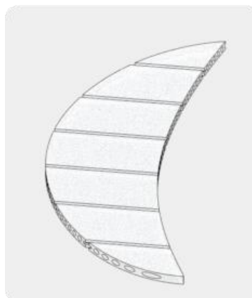
Ilustración 109. Entablado en madera plástica, escalón segundo piso de plataforma.
