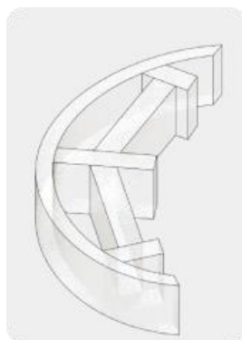
Ilustración 105. Viguetas en pino impregnado, segundo nivel de plataforma.
