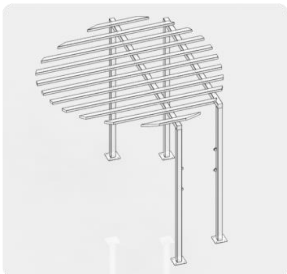
Ilustración 112. Pérgola en tubos de acero cuadrados y rectangulares.
