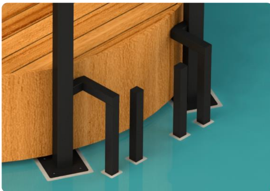
Ilustración 113. Estructura de acero para reposar bicicletas.
