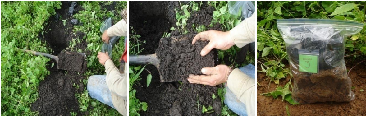
Fig. Extracción de muestras alteradas.
