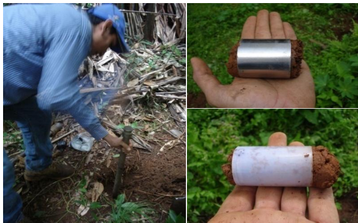
Figura 20. Extracción de muestras inalteradas
