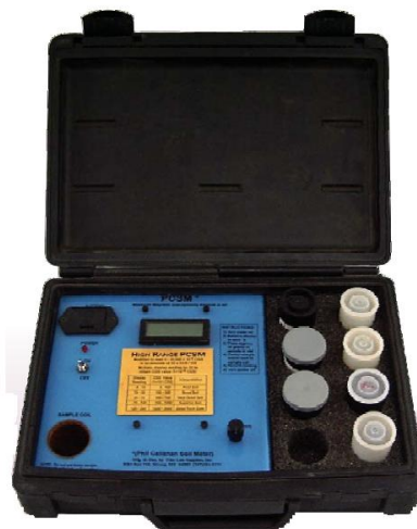
Figura 9. Dispositivo para medir el paramagnetismo del suelo PCSM (Paramagnetic Count Soil Meter)
