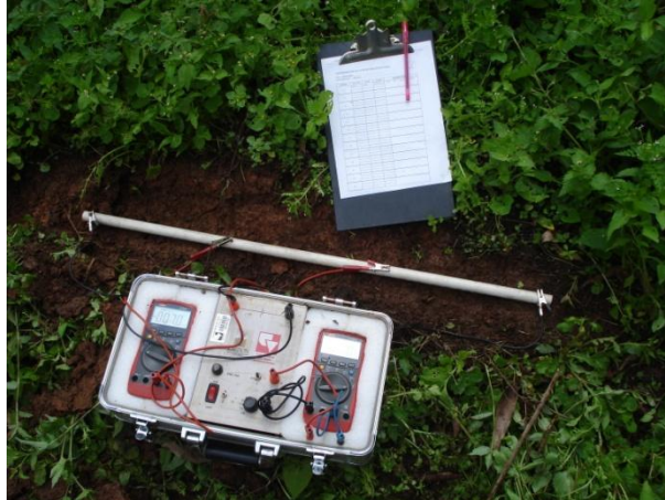
Figura 21. Toma de la resistividad eléctrica in situ.
