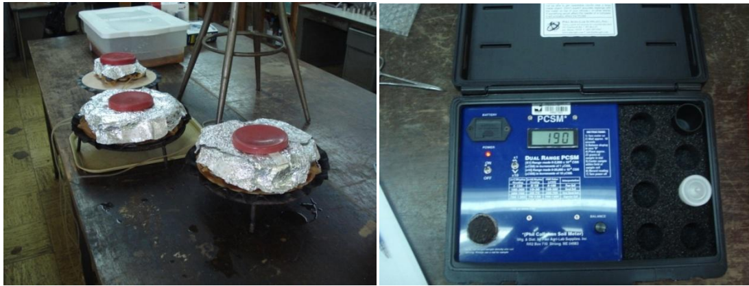
Figura 24. Drenaje y medición del paramagnetismo para cada muestra.
