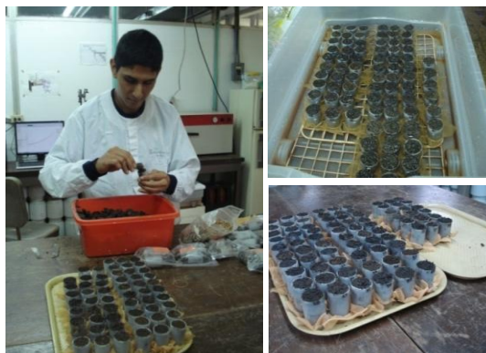
Figura 23. Enrasado y saturación muestras en los cilindros plásticos.
