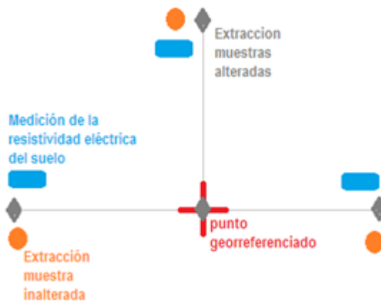
Figura 22. Diagrama de extracción de muestras de suelo por punto.
