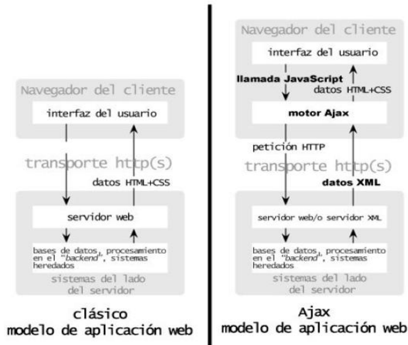
Figura 3: Diferencia entre el modelo clásico y Ajax
