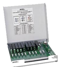
Figura 4-2. Equipo portátil de adquisición de datos del Laboratorio de Ingeniería Sísmica y Dinámica Estructural de la universidad del Valle (LINSE)
