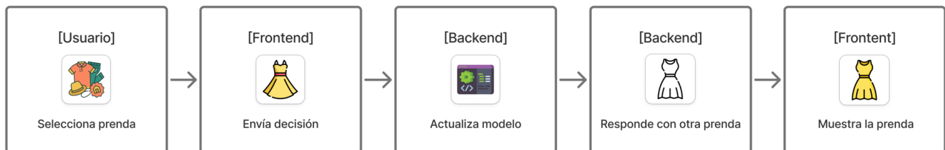
Figura 5.14: Flujo de comunicación entre usuario, frontend y backend en el sistema de recomendación.
