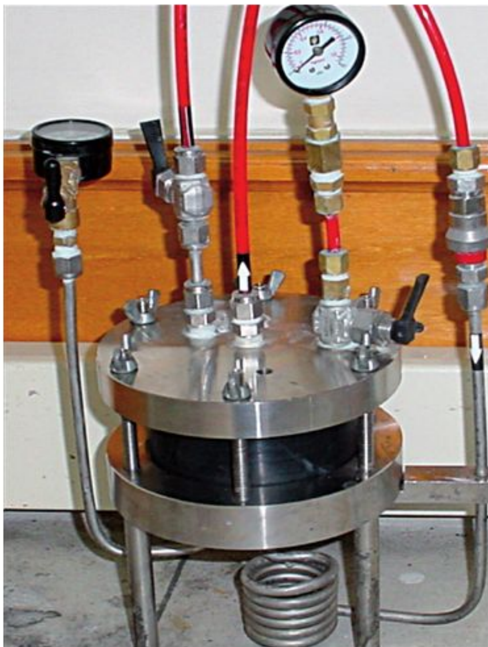
Fig. 2. Celda de permeabilidad CS-135. (Grupo de Superficies Electroquímicas y Corrosión GSEC-U.P.T.C sede central TUNJA-BOYACÁ).
