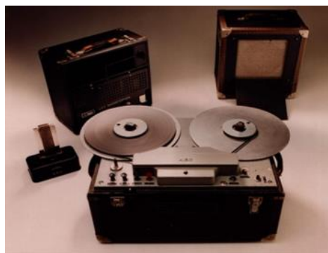
Imagen 1. Magnetofón K1, fabricado por AEG en 1935.
