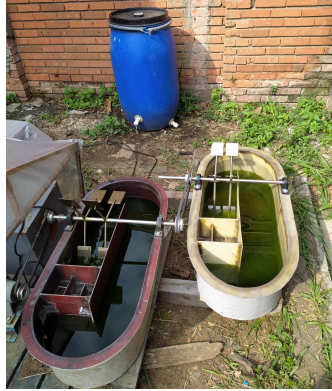
Figura 8. Sistemas de lagunas algales en estado de operación batch
