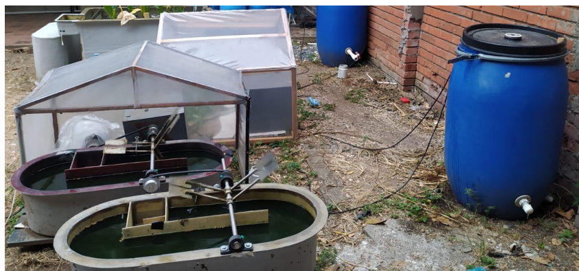
Figura 6. Esquema del sistema piloto de lagunas algales de alta tasa
