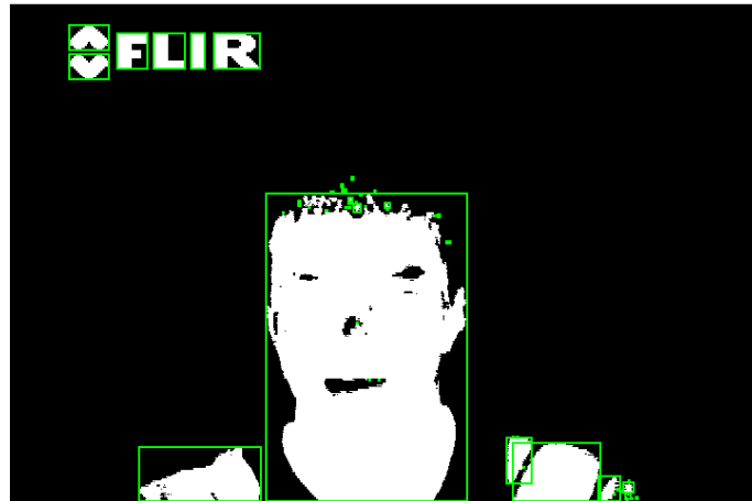
Ilustración 5-3. Rectángulos que contienen los objetos de la captura binarizada. Fuente: Autor.
