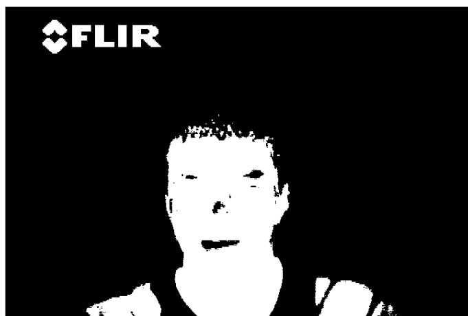
Ilustración 5-2. Captura del Rostro binarizada con umbral definido por el método de Otsu. Fuente: Autor.
