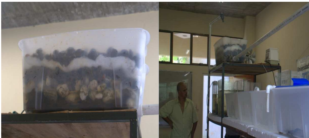
Figura 4 Filtro Mecánico del sistema cerrado. Figura 5 Contenedores plásticos
