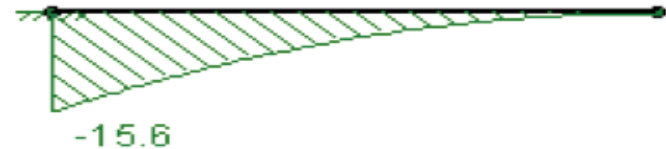
Ilustración 16 - Diagrama de momentos actuantes [Kgf-m]
