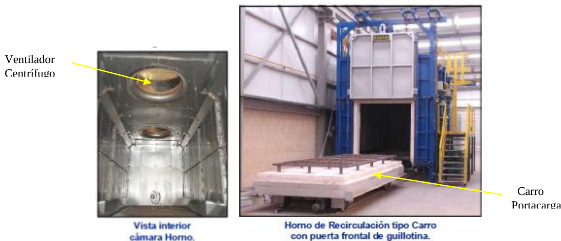
Figura 33. Horno de recirculación tipo carro con puerta frontal de guillotina.
