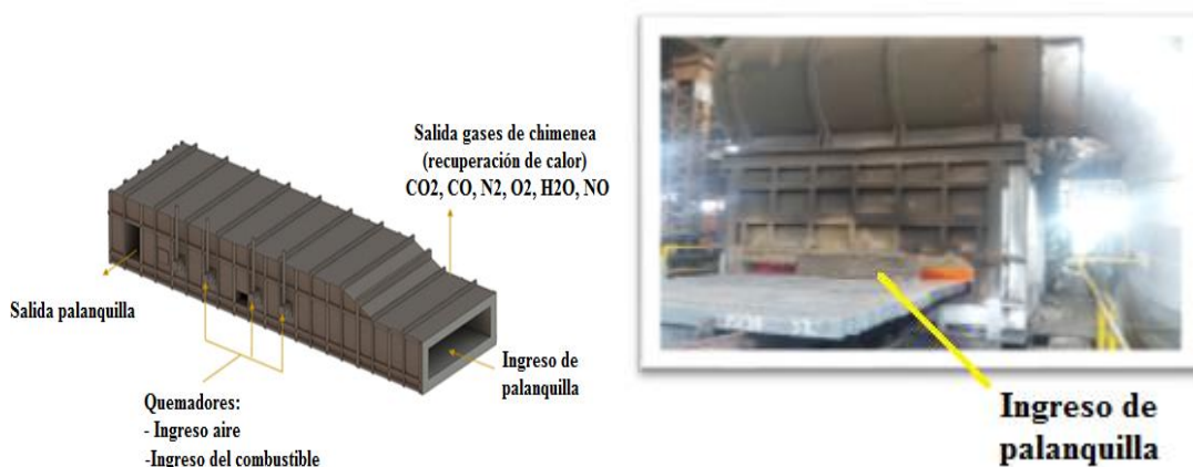
Figura 29. Hornos de empuje para calentamiento de palanquilla:
