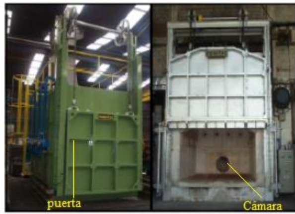
Figura 31. Horno de cámara con puerta tipo guillotina.
