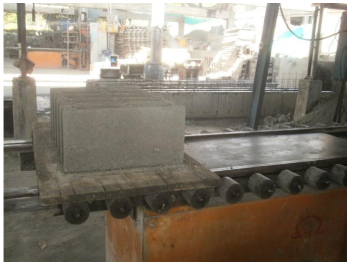
Figura 12. Bandas transportadoras de la bloquera
