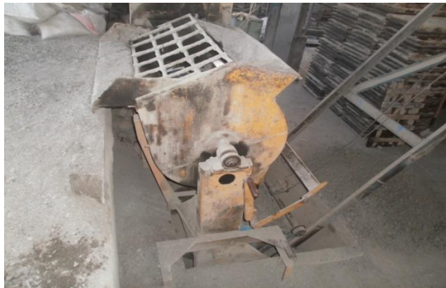
Figura 6. Concretadora Eje Horizontal.
