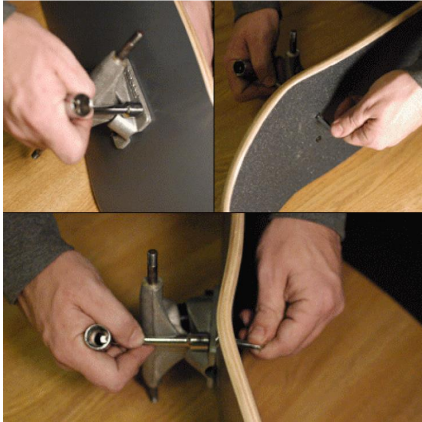
Figura 32 Fijación de trucks a la tabla Fuente: google.com consultado el 25-08-19.
