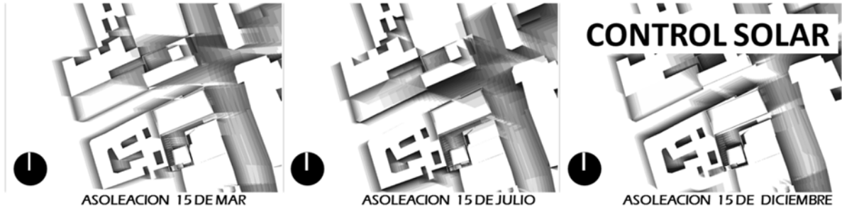
Ilustración 72 Simulaciones de Control solar. Fuente: Software Ecotect
