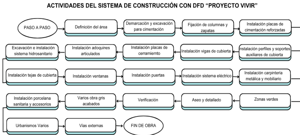
Figura 50. Actividades del sistema de construcción con DfD “Proyecto Vivir”. Fuente. Elaboración propia
