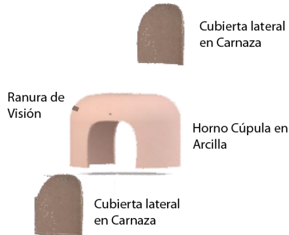
Figura 15, Horno Cúpula con vista explosionado/partes
